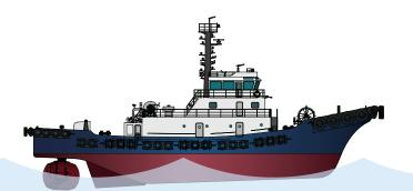
L.O.A : 41.50 m BREADTH : 11.00 m DRAUGHT : 3.5M GROSS TONNAGE : 396 GT MAX.SPEED : 13.00 knots BP, MAX : 85 ton MAIN ENGINES : YANMAR 8EY26W / 3,481PS x 750RPM 2SETS PROPULSION : KONGSBERG US 255 P30 FP TWIN 2,560kW x 750 RPM (100% MCR) GENERATOR : 168kW(210KVA) x AC225V x 60Hz x 3PH x 1800RPM ACCOMMODATION : 6 persons FUEL CAPACITY (m<sup>3</sup>) : 83m<sup>3</sup> FRESH WATER CAPACITY (m<sup>3</sup>) : 73.6m<sup>3</sup>
